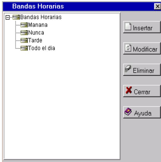
3) Si se quiere insertar una nueva Banda Horaria, se debe presionar el botón "Insertar" una vez posicionado sobre el ícono "Bandas Horarias", y se mostrará la siguiente ventana:
